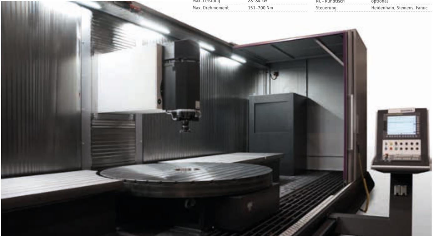
**SERIE ZVH MULTIPROCESS** 5-Achs-Fräs-Drehzentrum in Fahrständerbauweise
